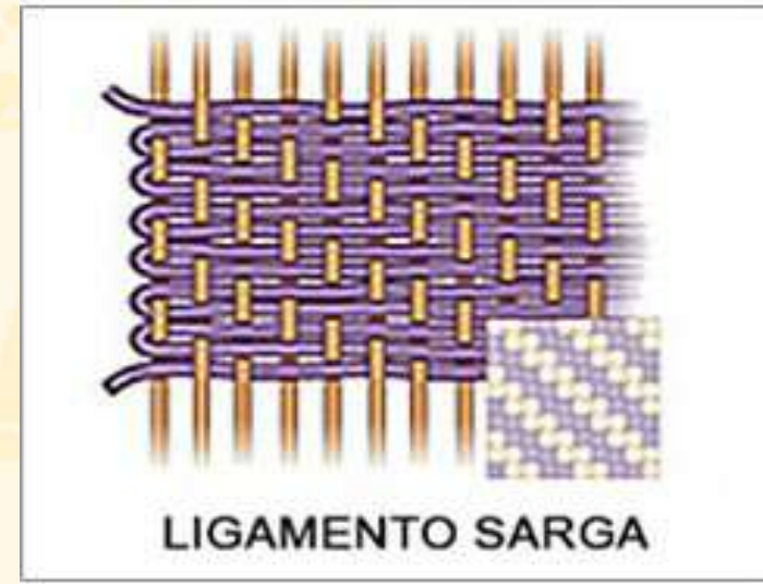
Ligamento sarga de 3 Ligamento sarga de 4 Ligamento sarga de sin revés de 4 o ligamento cruzado de 4.
